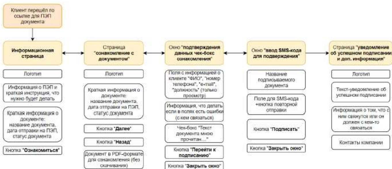
Схема 1. Логическая схема страниц и окон при подписании ПЭП электронных документов Клиентом в Системе ЭДО АНО НИИ Управления.
